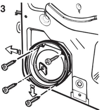
**I** Fissare il supporto altoparlante mediante le viti e le presteole fornite in dotazione. Per una corretta installazione si consiglia di fissare il supporto tenendolo il più possibile in avanti verso il basso.
